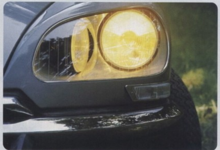
Die berühmten und einzigartigen Schwenkscheinwerfer gabs ab 1967 in einer völlig überarbeiteten Fahrzeugfront.
