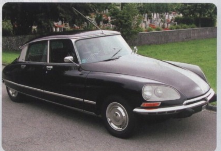
Diese DS 23 mit Jahrgang 1974 war bereits mit dem 130 PS starken, elektronisch eingespritzten 2347-ccm-Motor ausgerüstet und bis zu 190 km/h schnell.
